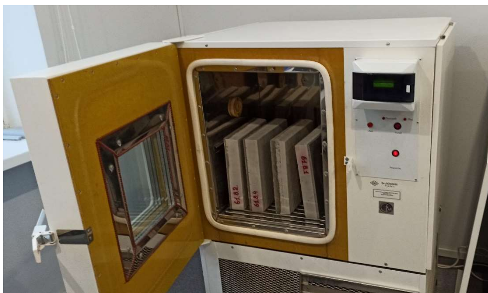
Рис. 3 Образцы в климатической камере в процессе испытаний
