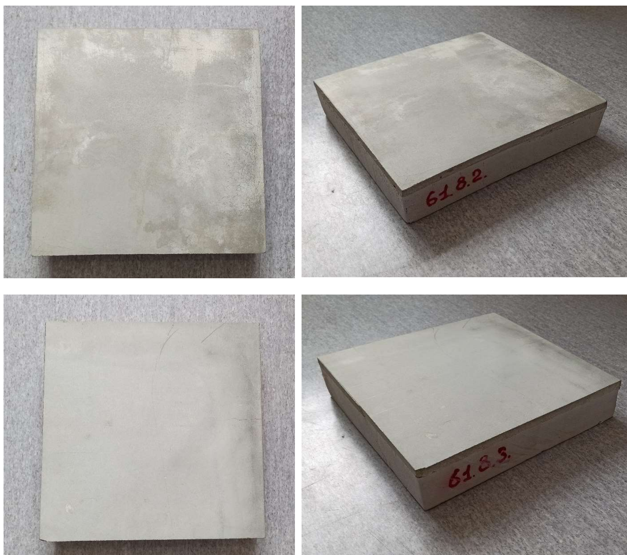
Рис. 8 Опытные образцы Сэндвич ТЕХНОНИКОЛЬ Ц-XPS после испытаний
